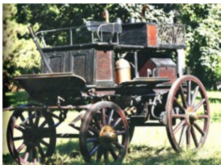
4. számú kép: Pécs város Köhler gyártmányú benzinmotoros fecskendője, 1907 (Bérczi et al., 2016a, 99.)
