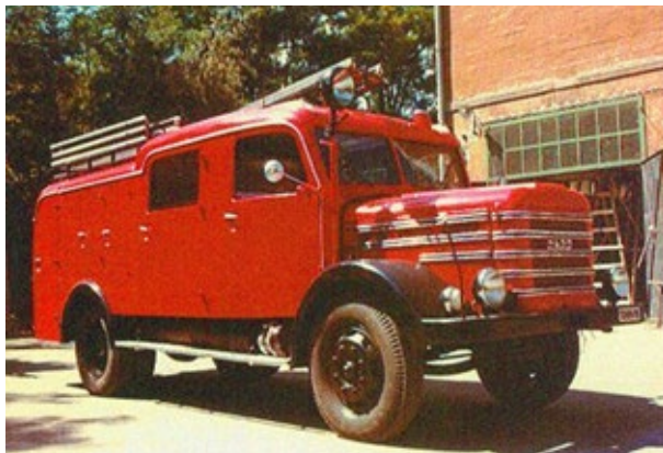
11. számú kép: CSD–420 tűzoltó gépjárműfecskenő, 1957 (URL3)
