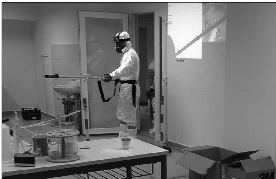
6. számú ábra: Teleszkópos táv-dózismérő eszköz a helyiség sugárzási szintjének felméréséhez. Forrás: A szerzők saját szerkesztése
